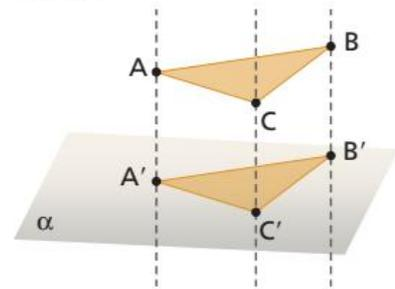
Desse modo, existe um vínculo entre os pontos da figura que se projeta com os pontos projetados, mas nem sempre a projeção ortogonal manterá toda a forma original da figura que se projeta.
