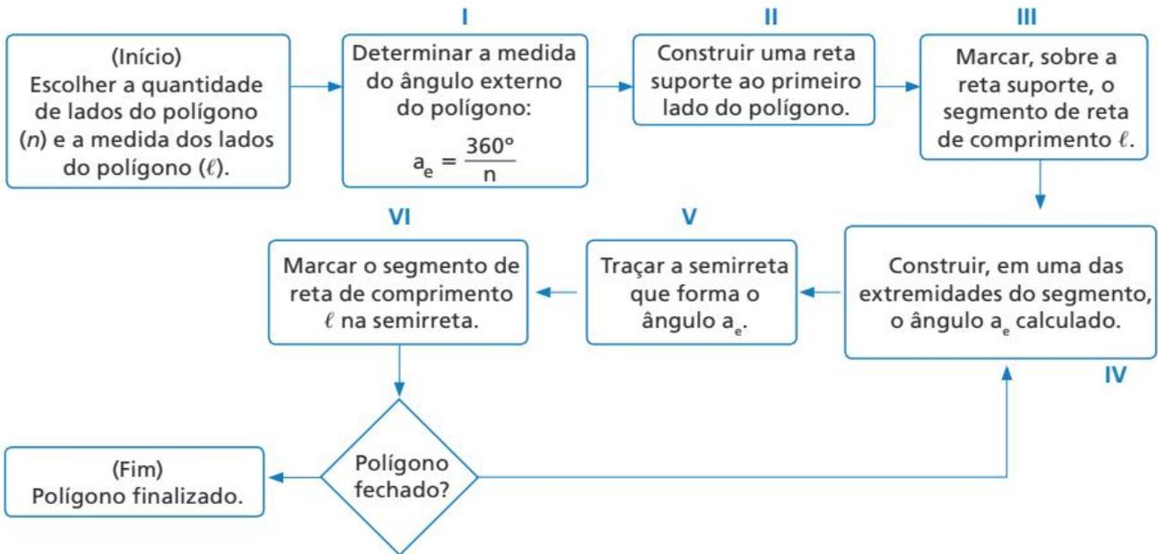
Seguindo as etapas de construção descritas no fluxograma, construímos um polígono regular qualquer. Observe, a seguir, como ficaria a construção de um pentágono regular.
