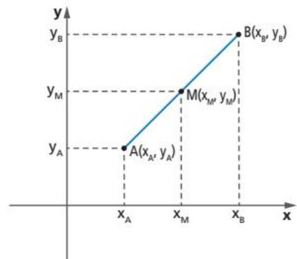
Conhecendo as coordenadas cartesianas  $(x, y)$  das extremidades de um segmento  $AB$ , também podemos determinar seu comprimento, que é a **distância ( $d_{AB}$ ) entre os pontos A e B**. Para isso, vamos considerar o segmento  $AB$  representado ao lado.
