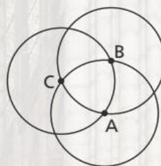
**3** Com a ponta-seca do compasso em um dos pontos onde as duas circunferências desenhadas se cruzam, e com a mesma abertura usada nos passos anteriores, trace uma nova circunferência.
